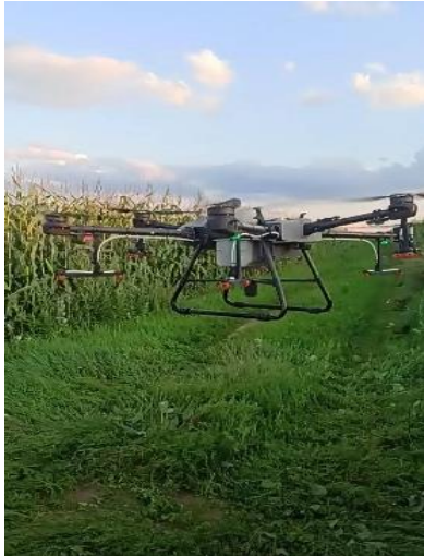
Рисунок 1. Позакореневе внесення робочої суміші пестицидів за допомогою аеродрона DJI AGRAS на дослідях кукурудзи
